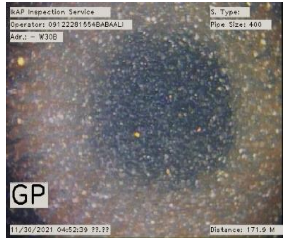
شکل ۹. کیفیت نامطلوب آب چاه تنکمان پس از نشست و شکل ۱۰. موقعیت مکانی چاه تنکمان و قرارگیری در ناحیه فرونشست جدی
