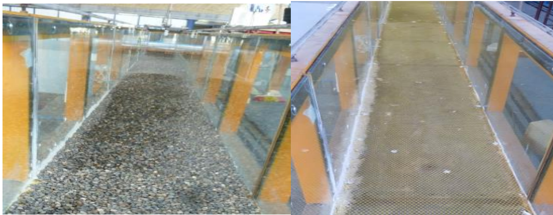
شکل ۷- زبری ایجاد شده با ذرات شن K_s = 15\text{mm} شکل ۸- زبری ایجاد شده با توری پلاستیکی K_s = 4\text{mm}
