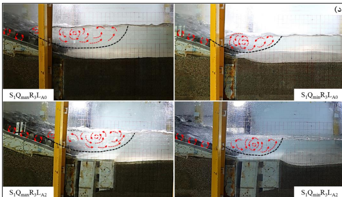
شکل ۶- موقعیت پرش هیدرولیکی در پایین دست سازه کنترل تراز بستر سطح شیب‌دار در حضور کفبند به طول P ( L_{A2} ) و بدون کفبند ( L_{A0} ): الف) بدون اعمال زبری، ب) چیدمان متراکم با زبری متوسط 1/15 سانتی‌متر، ج) چیدمان متراکم با زبری متوسط 5/2 سانتی‌متر و د) چیدمان یک در میان با زبری متوسط 5/2 سانتی‌متر- ادامه
