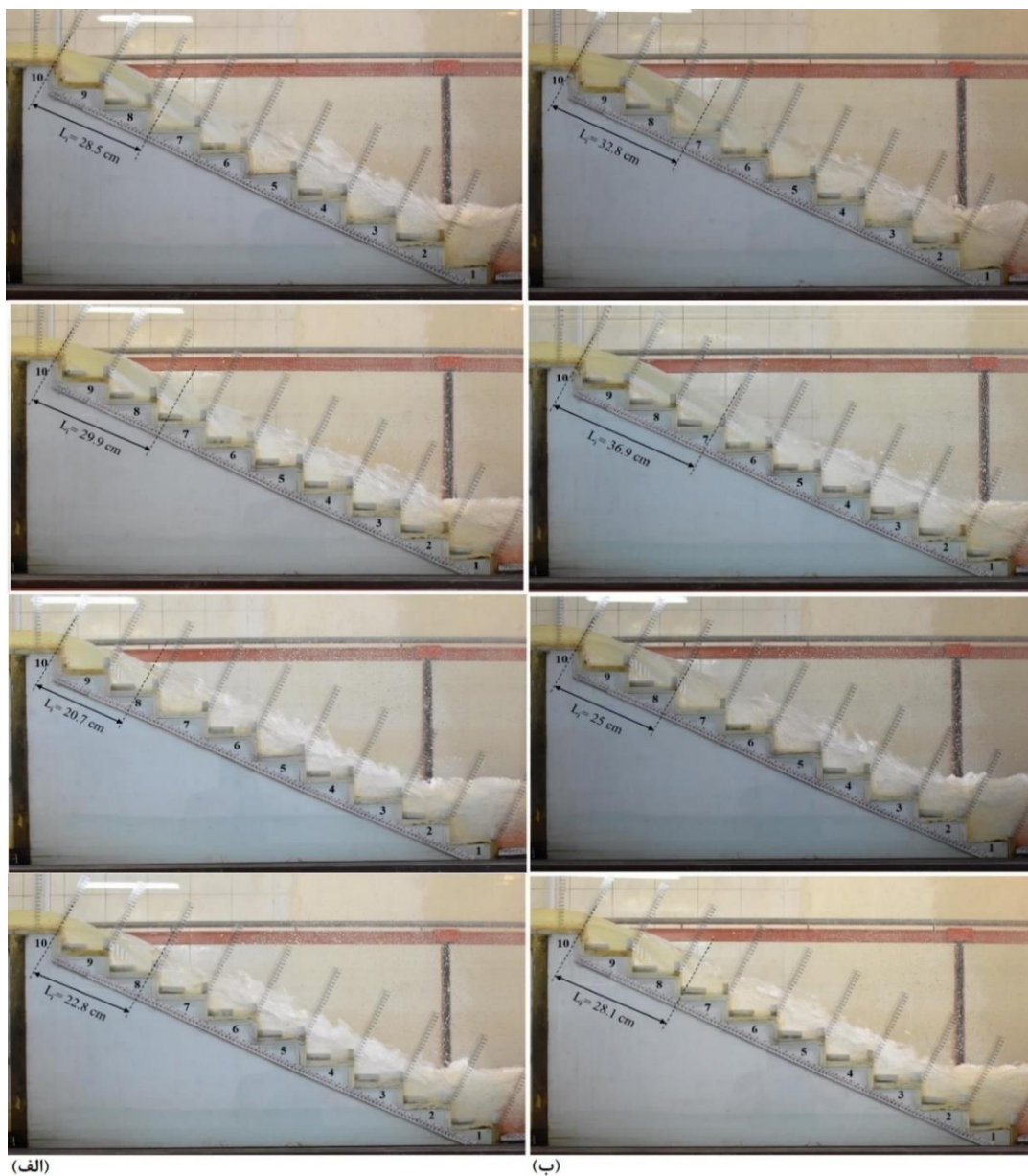
شکل ۱۲. نقطه شروع هوادهی جریان بر روی مدل‌های ترکیبی سرریز پلکانی تمام استخر الف: دبی ۴۰ لیتر بر ثانیه ب: دبی ۵۰ لیتر بر ثانیه
