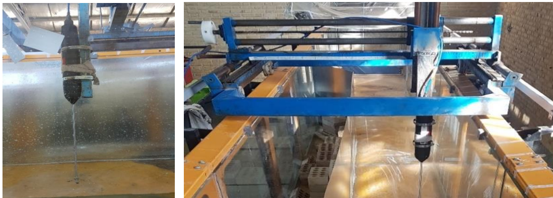
شکل ۲. سرعت‌سنج سه بعدی به همراه کالسکه قابل حرکت بر روی کانال
