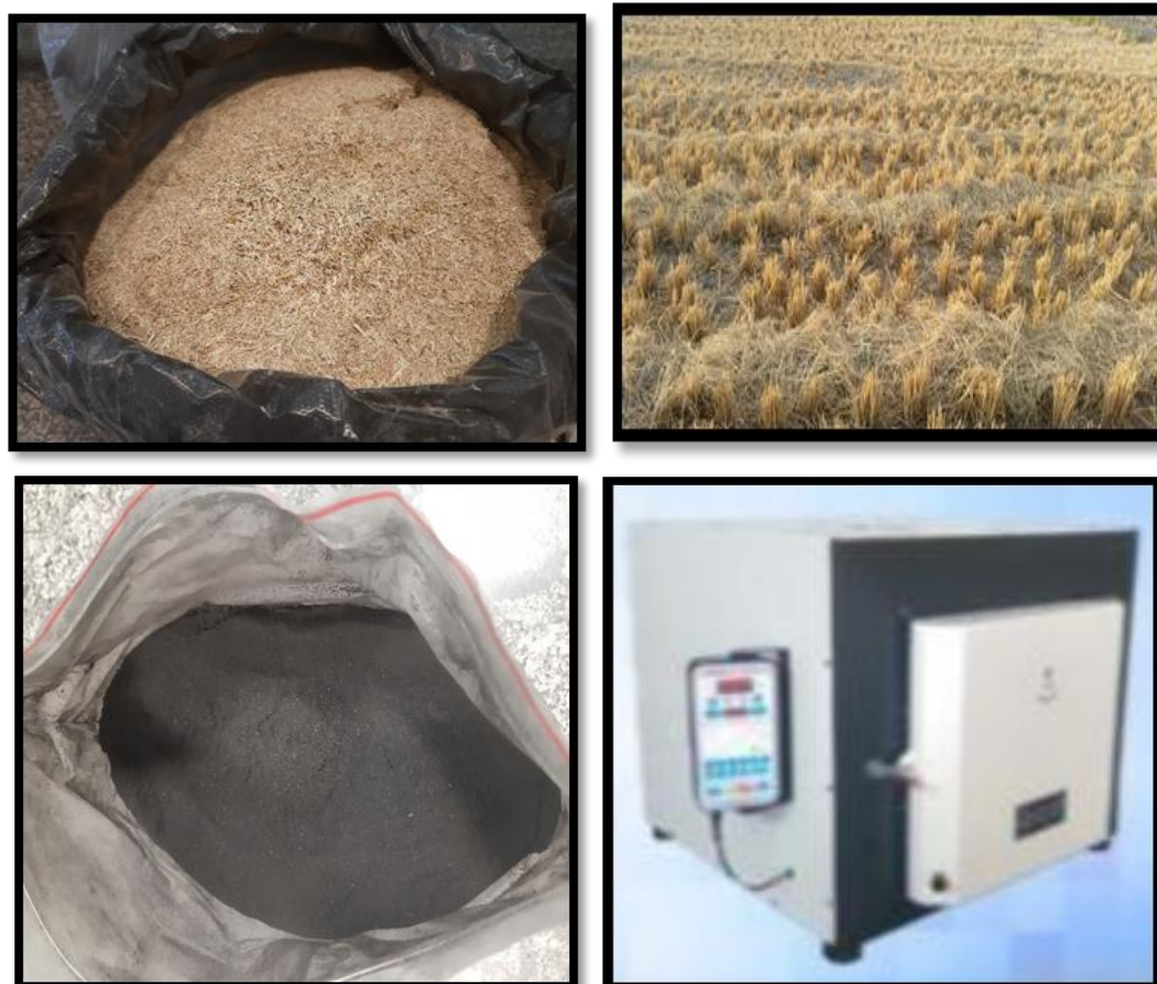
شکل ۱- تهیه بیوپچار از کاه و کلش برنج در کوره الکتریکی جهت کاربرد با خاک
