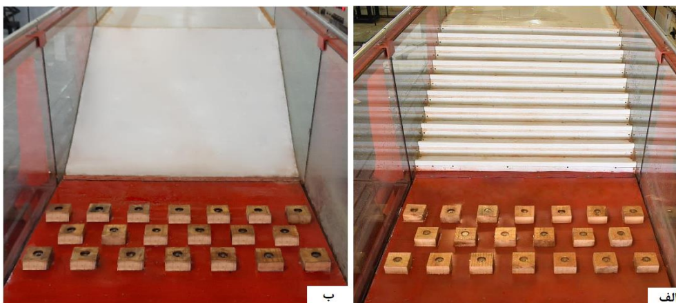
شکل ۲- مدل‌های آزمایشگاهی: الف) مدل شوت پلکانی ب) مدل شوت صاف
