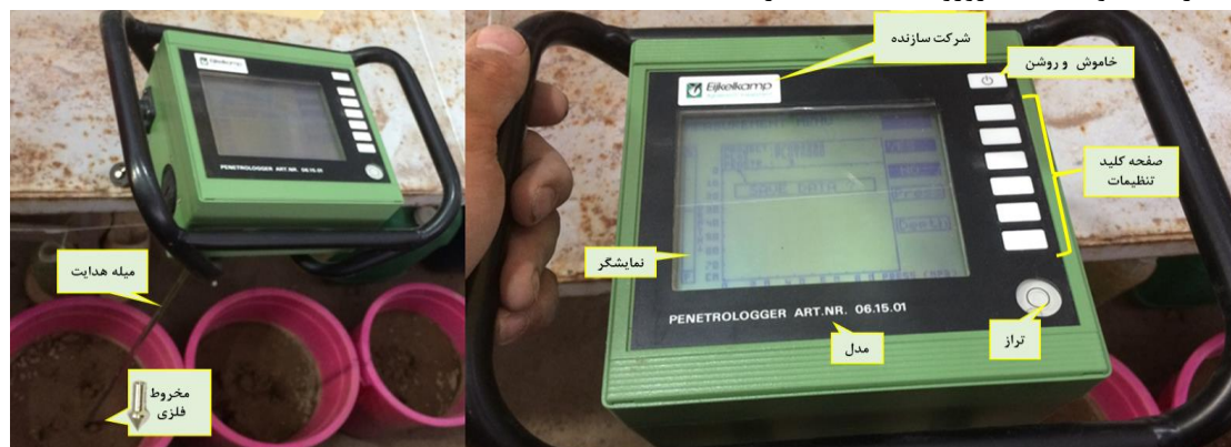
شکل ۴- فروسنج مخروطی مورد استفاده برای اندازه‌گیری مقاومت مکانیکی خاک
