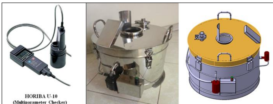
شکل ۳- دستگاه اندازه‌گیری SOD (طراح و سازنده: عشایی، ع.) همراه با دستگاه پرتابل سنجش پارامترهای کیفی آب (ساخت شرکت ژاپنی HORIBA)
