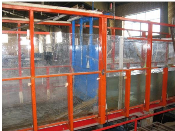
شکل ۴- نمایی از کانال و دریچه کشویی نصب‌شده
