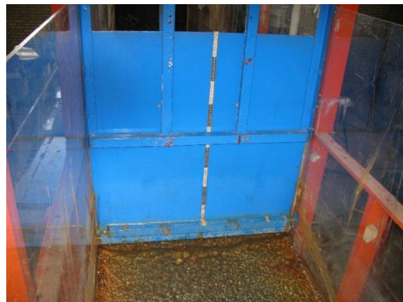
شکل ۴- نمایی از کانال و دریچه کشویی نصب‌شده
