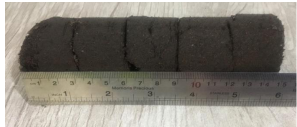
شکل ۲- ستون خاک برش یافته به قطعات ۳ سانتی‌متری پس از پایان آب‌شویی
