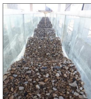
شکل ۲- سمت راست: کانال با فرم بستر RP1. سمت چپ: کانال بدون فرم بستر
