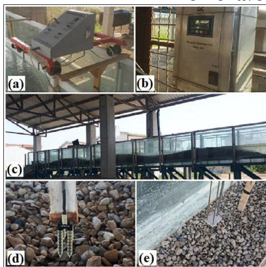
شکل ۳- a: عمق سنج، b: فلومتر، c: نمای جانبی کانال آزمایشگاهی با فرم بستر RP3، d: حسگر اندازه‌گیری هدایت الکتریکی، e: لوله پیتوت
