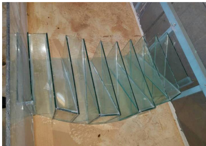
شکل ۱- مدل هیدرولیکی سرریز کلید پیانویی قوسی مورد مطالعه
