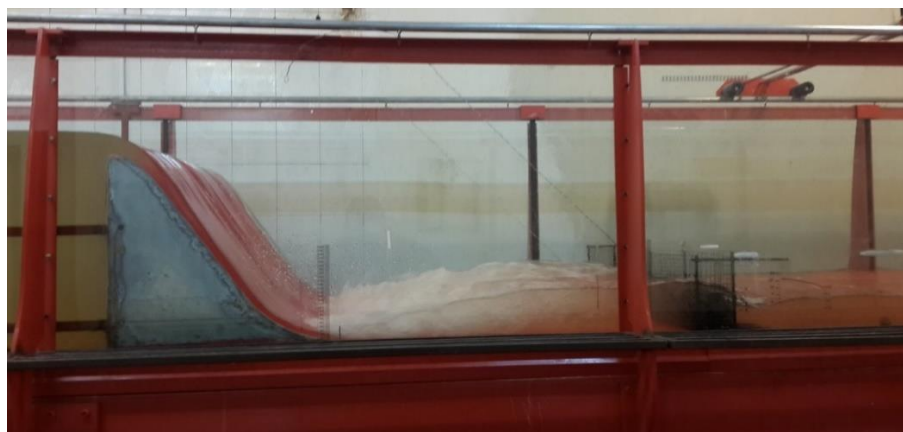
شکل ۳- نمایی از مدل آزمایشگاهی و پرش هیدرولیکی در پنجه سرریز
