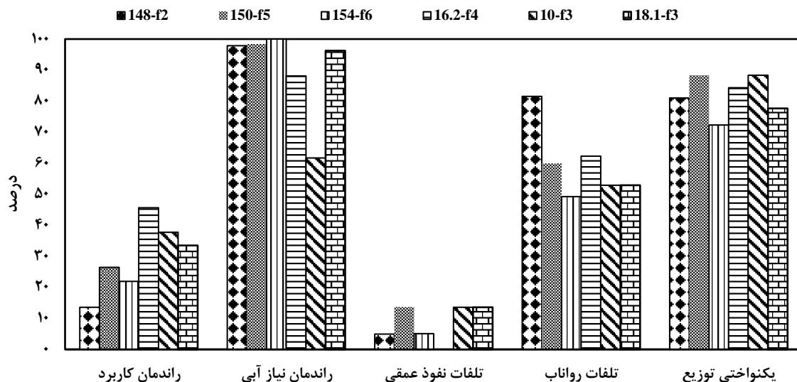
شکل ۱- میانگین راندمان کاربرد (Ea)، راندمان نیاز آبی (Er)، یکنواختی توزیع (DU)، تلفات نفوذ عمقی (DPR) و رواناب (TWR) در مزارع مورد بررسی در مناطق دیلم و BC در کشت و صنعت شهید بهشتی
