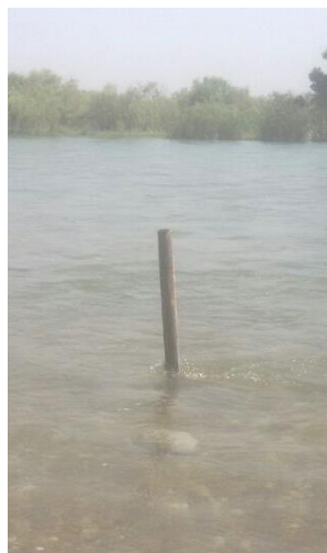
شکل ۲- شکل شماتیک و نمای واقعی از روش اندازه‌گیری هدایت هیدرولیکی عمودی ( K_v ) در بستر رودخانه
