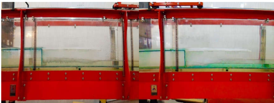
شکل ۲. شرایط مختلف ایجاد تلاطم در شیب‌شکن‌های قائم مجهز به صفحه مشبک افقی با جریان فوق بحرانی در بالادست
