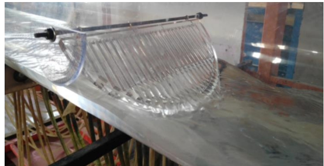
شکل ۷- نحوه قرارگیری محور افقی صفحه آویخته در طول کانال دایره‌ای
