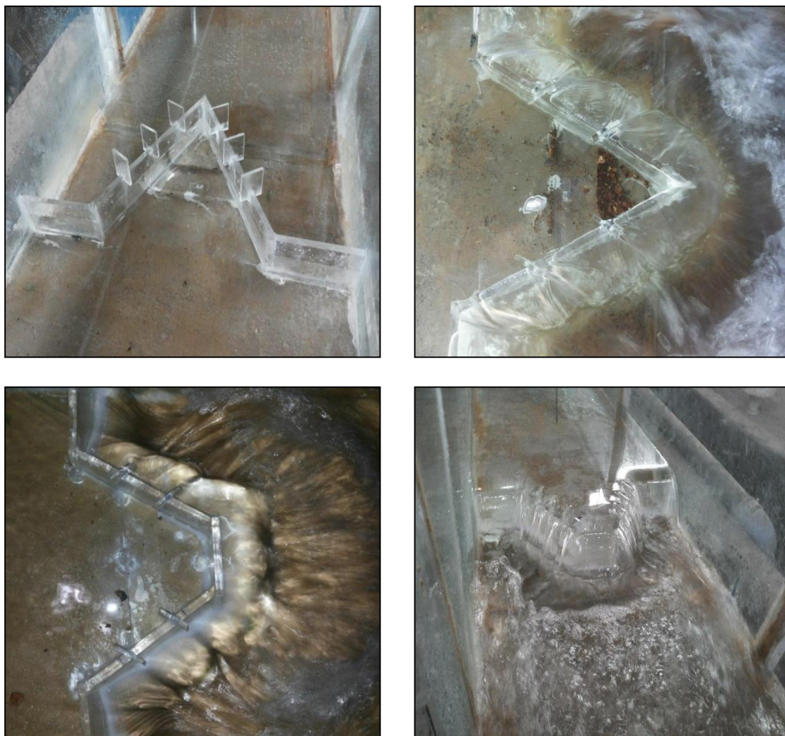
شکل ۳. نمونه ساخته شده از مدل فیزیکی سرریزهای زیگزاگی مثلثی و دوزنقه ای در تحقیق حاضر
