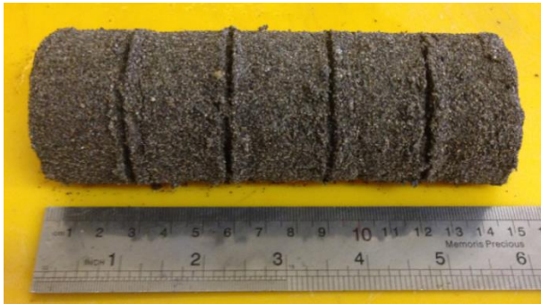
شکل ۲. ستون شن MICCP بریده شده به بخش‌های ۳ سانتی‌متری پس از آب‌شویی
