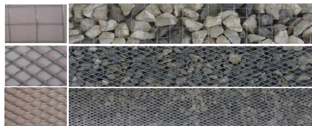
شکل ۶- توری‌های مورد استفاده در ساخت مانع توری‌سنگی
