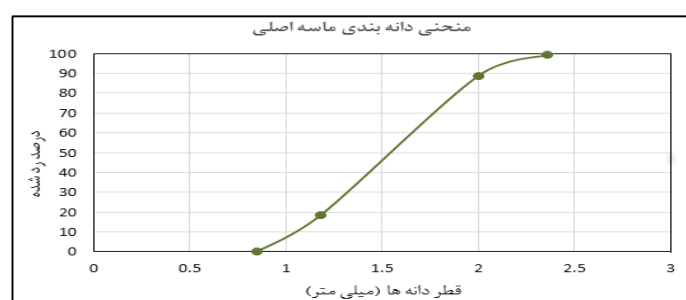
شکل ۳- منحنی دانه بندی مصالح مورد استفاده جهت بستر فرسایش پذیر
