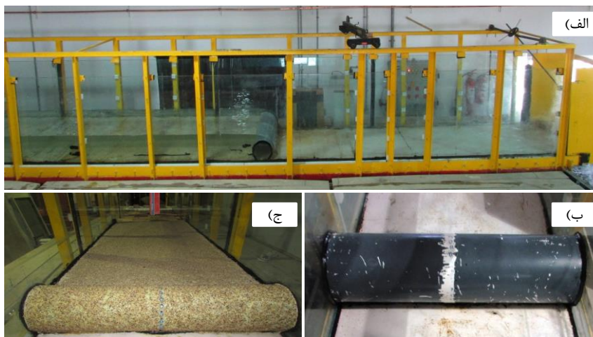
شکل ۲. تصاویری از (الف) فلوم آزمایشگاهی، (ب) سرویز استوانه‌ای و (ج) تراز رسوب گذاری در بالادست و سرویز استوانه‌ای زبر
