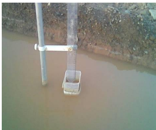
شکل ۵- اشل اندازه‌گیری ارتفاع آب
