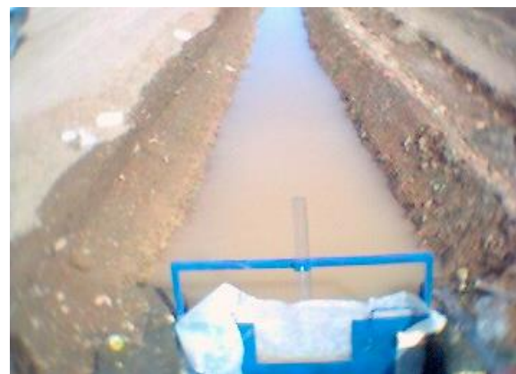
شکل ۱۴- آزمایش برکه در پشت دریچه‌ها
