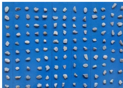
شکل ۴- عکس دیجیتالی تهیه شده از نمونه ذرات سنگریزه
