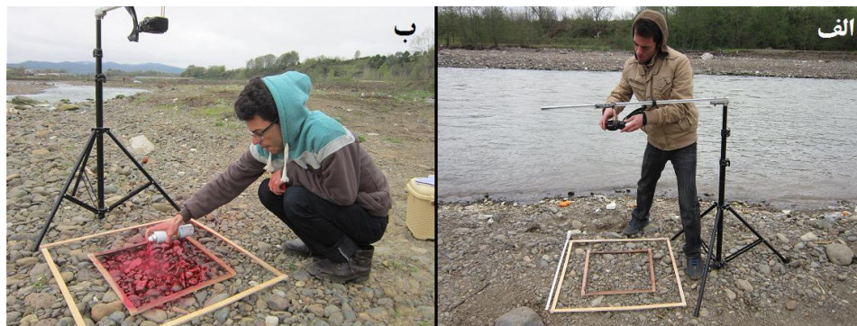
شکل ۳- عملیات میدانی: الف) تصویربرداری از ذرات رسوبی بستر با استفاده از تجهیزات موجود و ب) رنگ‌پاشی ذرات سطحی موجود در قاب ۴۰ سانتی‌متری
