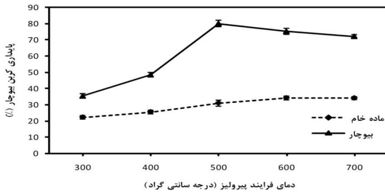
شکل ۴. درصد کربن آلی پایدار باقی‌مانده در بیوجار تولید شده از کود گاوی در مقایسه با ماده اولیه خام در دماهای مختلف. مقادیر Error bar از انحراف خطای سه تکرار به دست آمده است.
