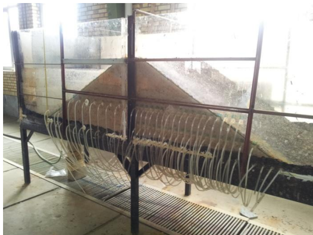
شکل ۲. تصویر مدل آزمایشگاهی سد خاکی ساخته شده و پیزومترهای نصب شده در بدنه مدل (عکس از پایین دست سد)
