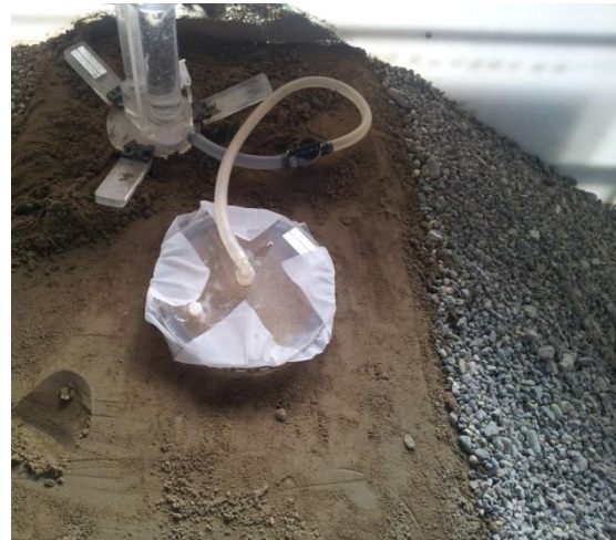
شکل ۵. دستگاه نفوذسنج مکشی دیسک قرارگرفته روی بدنه سد جهت اندازه گیری هدایت هیدرولیکی غیر اشباع
