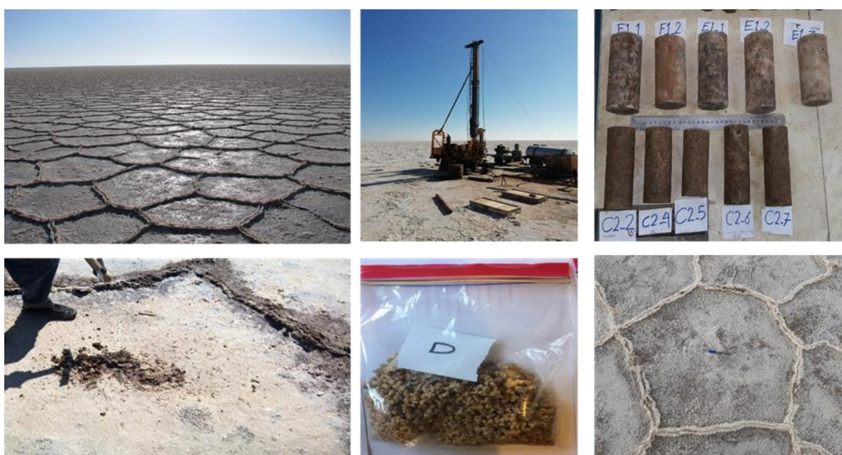
شکل ۲. پلایا، دستگاه مغزه‌گیری، نمونه‌های مغزه، پلیگون‌های منطقه مورد مطالعه و نمونه‌برداری از آن‌ها به منظور اندازه‌گیری پارامترهای مورد نیاز
