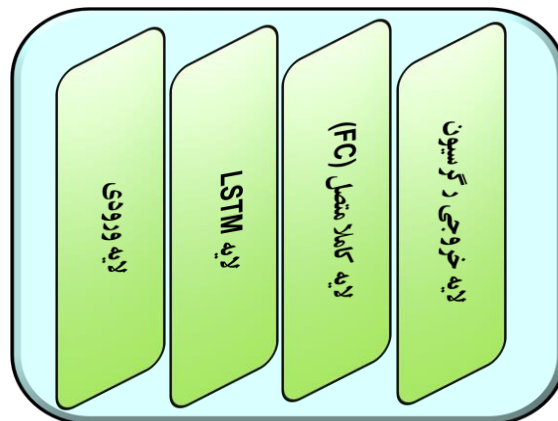
شکل ۲. معماری کلی یک پیش‌بینی‌کننده مبتنی بر LSTM
