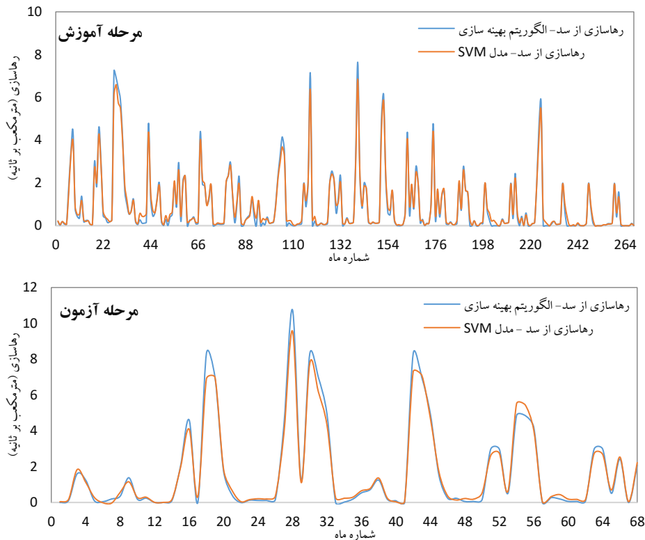
شکل ۸. پیش‌بینی میزان رهاسازی بهینه از سد جامیشان توسط مدل ماشین بردار پشتیبان در مراحل آموزش و آزمون
