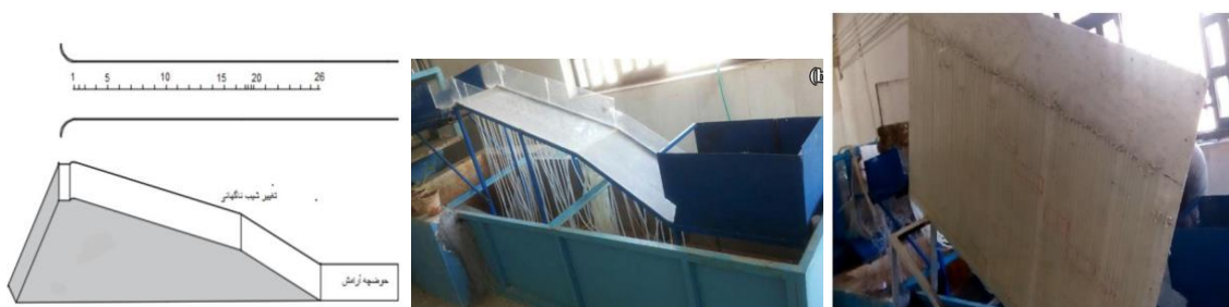
شکل ۷- نمایی از مدل فیزیکی سرریز سد سورک و تابلوی پیزومترها (Samadi et al, 2020)
