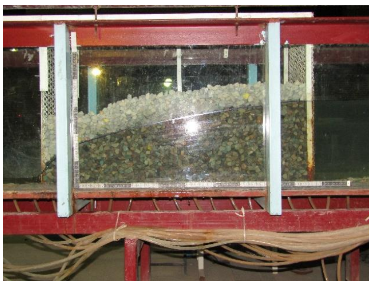
شکل ۴- عکس دیواره کناری فلوم برای تعیین عمق جریان عبوری از داخل محیط متخلخل
