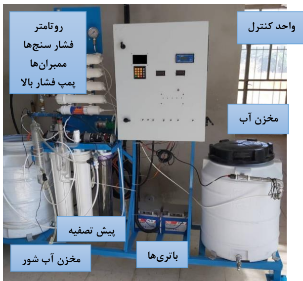
شکل ۱- نمایی از سامانه PV-RO ساخته شده و اجزای آن
