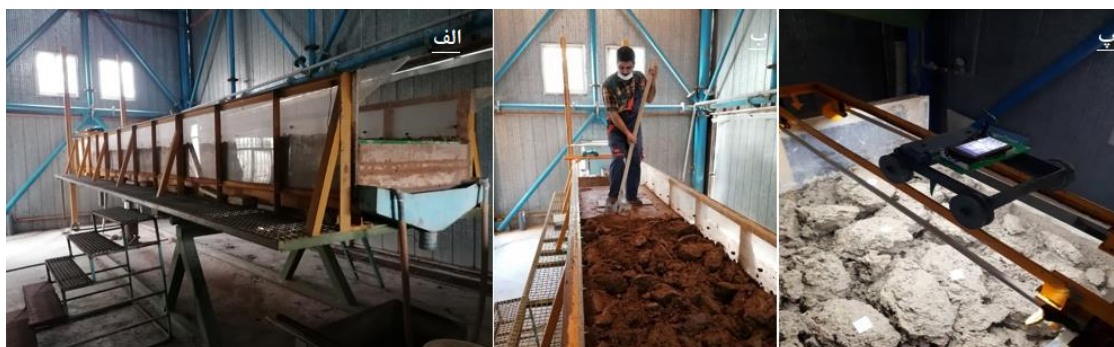
شکل ۱- الف: فلوم آزمایشگاهی، ب: شخم زدن فلوم به کمک بیل و پ: ریل عکس‌برداری در فلوم آزمایشگاهی.
