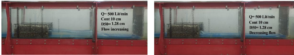
شکل ۷- رفتار هیسترتیک جریان در برابر تنگ‌شدگی گابیونی
