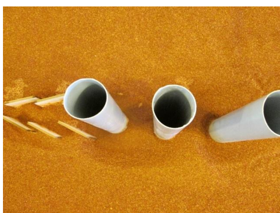
شکل ۱۰- تصاویر شرایط آبشستگی پس از اتمام آزمایش (عدد فرود ۰,۲۵)
