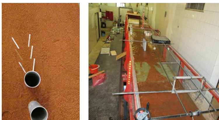
شکل ۲- فلوم آزمایشگاهی در تحقیق حاضر و مدل آزمایشگاهی با حضور صفحات مستغرق
