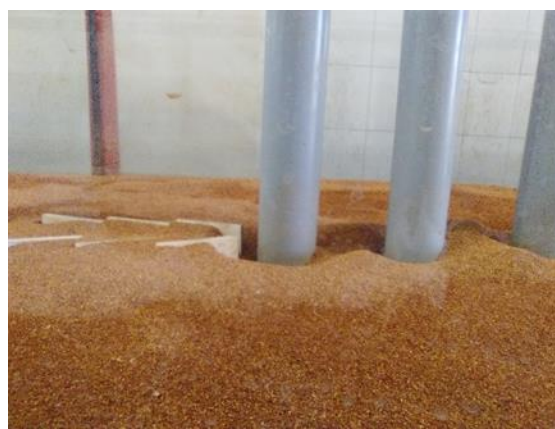
شکل ۱۰- تصاویر شرایط آبشستگی پس از اتمام آزمایش (عدد فرود ۰,۲۵)
