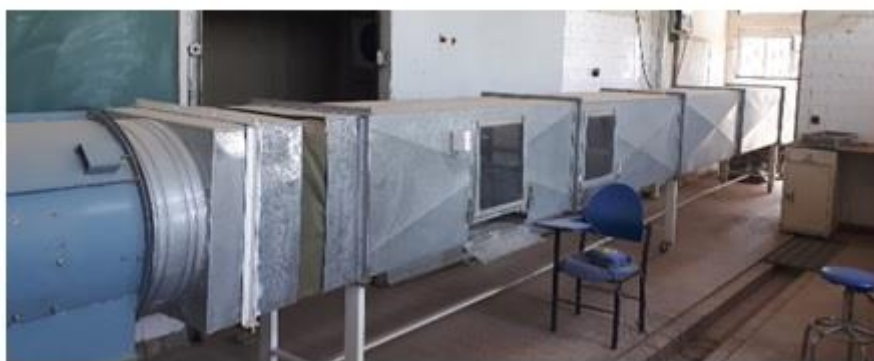
شکل ۲- تونل باد ثابت آزمایشگاه تحقیقات گرد و غبار دانشگاه شهید چمران اهواز
