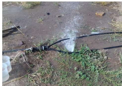
شکل ۸- ترکیدگی در تیپ به دلیل انتخاب طول نامناسب (این آزمایش بدون شیر کنترل انجام شده است)
