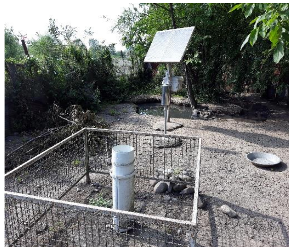
شکل ۱۲- ایستگاه تبخیرسنجی فاقد مشخصات و عدم رعایت حریم
