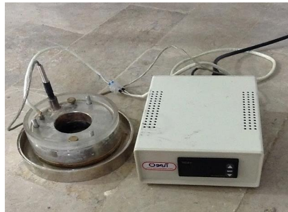
شکل ۵- دستگاه طراحی شده به منظور تامین دمای مورد نیاز برای انجام آزمایش تحکیم حرارتی
