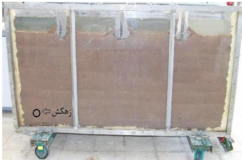
شکل ۳- نمایشی از تصویر واقعی مدل فیزیکی، پس از کرت‌بندی سطح خاک
