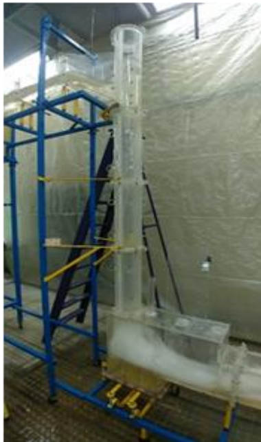
شکل ۱- الف) طرح اولیه و نمای جانبی سازه ریزشی گردابی، ب) پلان سازه ورودی مماسی، ج) مقطع مخزن مستهلاک کننده و د) مدل فیزیکی سازه ریزشی گردابی شبکه فاضلاب شرق شهر تهران (ایران)
