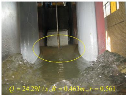
شکل ۷- تغییرات نیمرخ عرضی سطح آب و عدد فرود جریان در گلوگاه به ازای شرایط مختلف آزمایشگاهی
