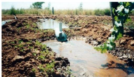
فلوم SMBF نصب شده در یک نهر آبیاری - نیومکزیکو - ساننافه
