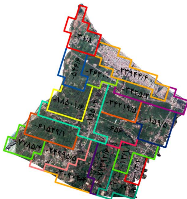
شکل ۶. ناحیه‌بندی محدوده مطالعاتی و مقدار تخلیه خالص مربوط به هر ناحیه بر حسب مترمکعب در سال
