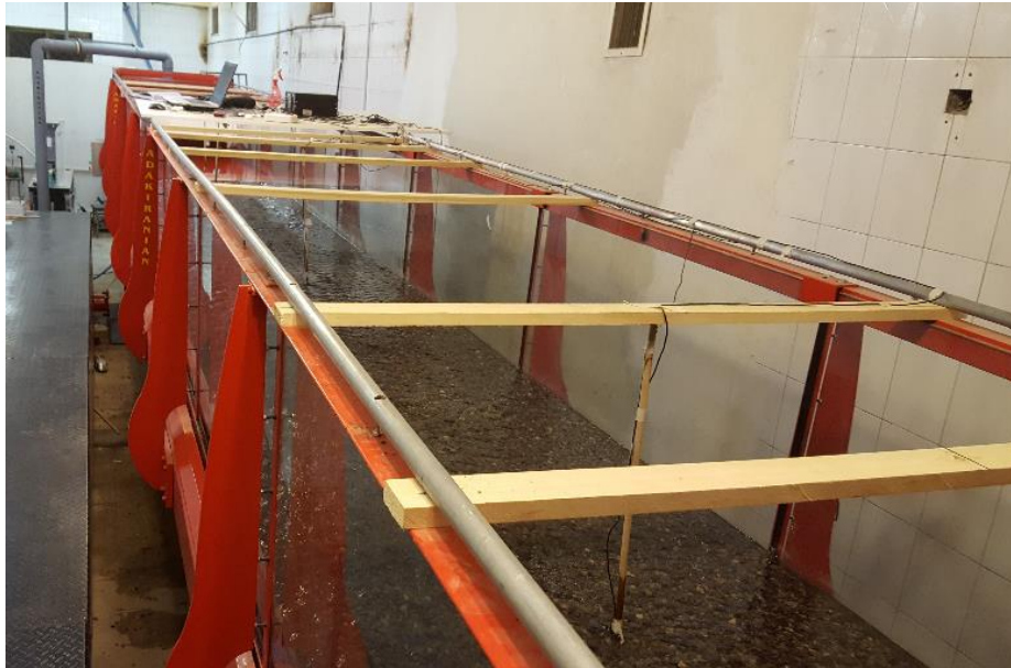
شکل ۳. کانال آزمایشگاهی با بستر سنگریزه‌ای و جانمایی سنسورهای اندازه‌گیری هدایت الکتریکی
