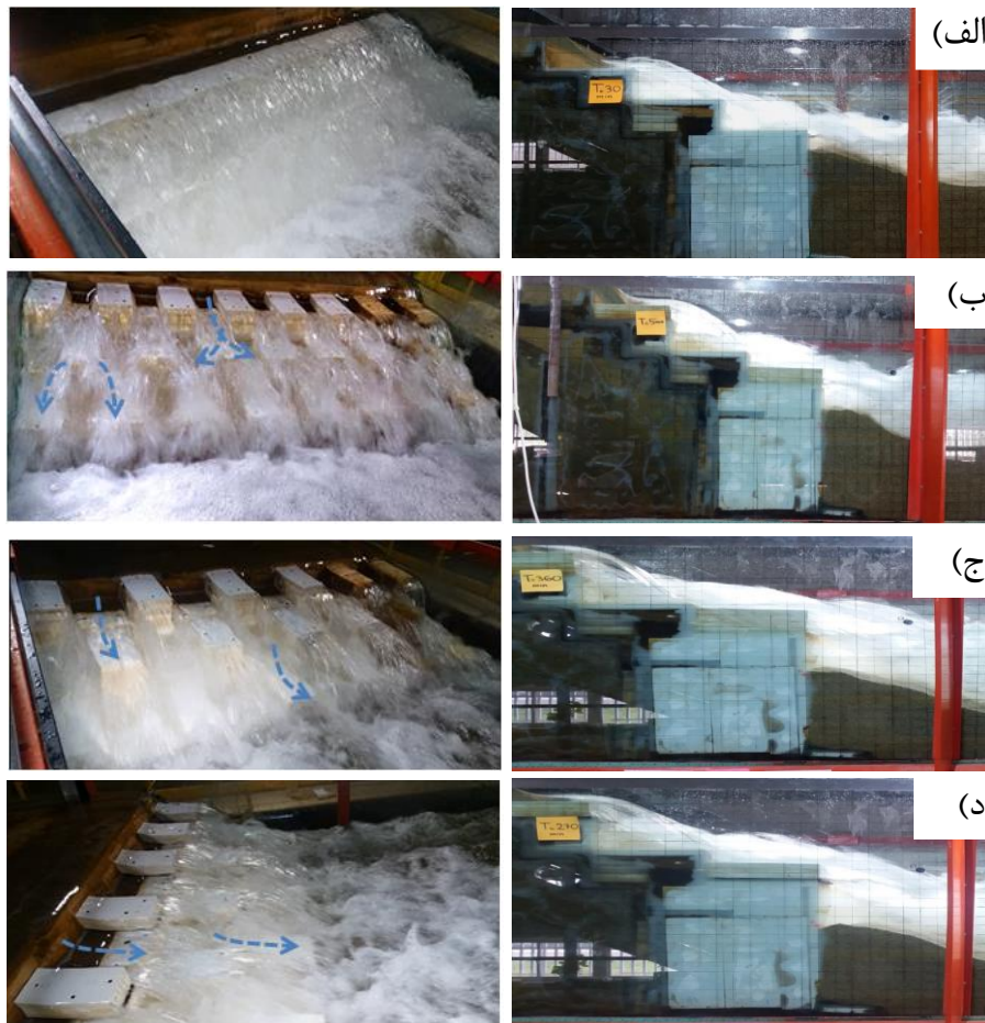
شکل ۱۵- الگوی جریان عبوری در عمق پایاب 2/5 y_c و 4/5 y_c ( q=0.33 m^3/m.s و \eta=14/9 ) در سرریزهای: الف) WL_2 ، ب) L1_2 ، ج) L2_2 و د) L3_2
