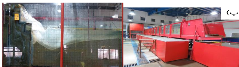
شکل ۳- الف) طرح کلی از فلوم آزمایشگاهی و ب) تصاویری از فلوم آزمایشگاهی و سرریز پلکانی-کنگره‌ای
