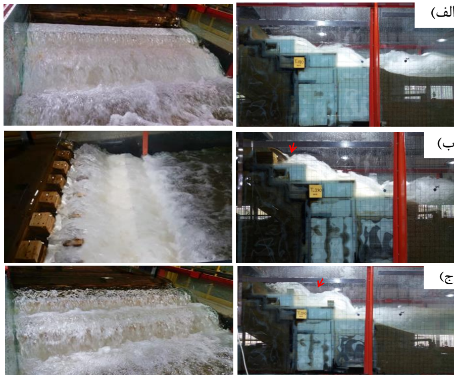
شکل ۱۷- الگوی جریان عبوری در عمق پایاب 4 y_c و y_c/h=0/48 و q=0/022 m^3/m.s و \eta=7/2 در سرریزهای:
