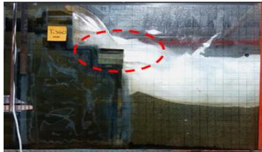
شکل ۱۳- الگوی جریان عبوری از سرریز پلکانی-کنگره‌ای L21 در y_c/h=0/54 و q=0/04 m^3/m.s و \eta=6/3 و عمق پایاب 4y_c
