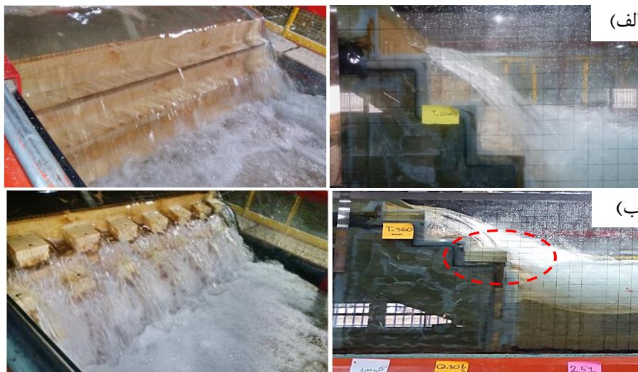
شکل ۱۲- نمایی از الگوی جریان در عمق پایاب 2/5y_c و y_c/h=0/34 و q=0/02m^3/m.s و \eta=10 روی سرریزهای:
