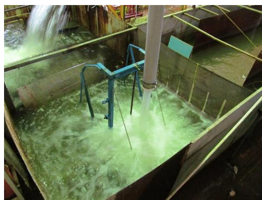
شکل ۳- نمایی از مدل جت خروجی از نازل و صفحه برخورد
