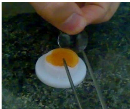
شکل ۴. نمای کلی از برداشت لایه جاذب از ابزار DGT
