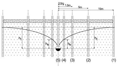
شکل ۲- موقعیت پیزومترهای نصب شده نسبت به لوله زهکش زیرزمینی
