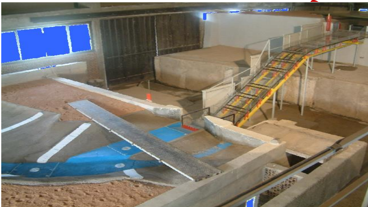
شکل ۳. مدل هیدرولیکی سرریز سد نازلو (بی‌نام، ۱۳۸۶)
